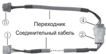
Рис.26. Схема подключения переходника и соединительного кабеля:
